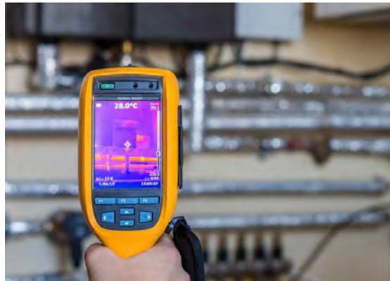
Mit der Thermokamera kann ungewollte Heizungsaktivität – auch im Sommer – zuverlässig aufgespürt werden.
