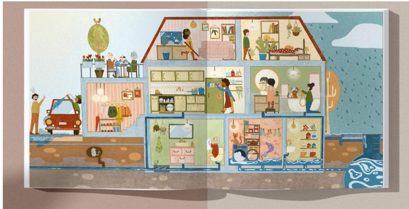
Auf dieser Seite sieht man auch das Regenwasser. Der starke Regen rechts füllt die Kanalisation mit Regenwasser. Der Kanal liegt auf gleicher Höhe wie die Abwasserrohre des Hauses. Das Wasser aus dem Kanal kann in die Rohre fließen und dann in den Keller. Es staut sich in den Keller zurück.
