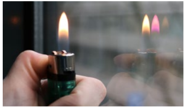
Ein andersfarbiges Spiegelbild einer Feuerflamme zeigt die Beschichtung einer Scheibe bei Wärmeschutzglas.
